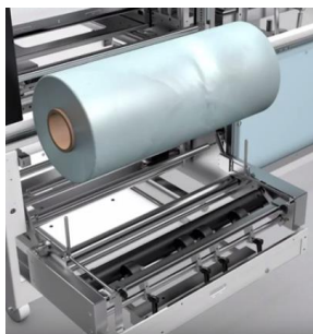
Carro extraíble para carga fácil del film
