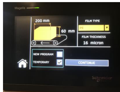
Mediendo las medidas del prod., la máquina ajusta el film automáticamente
